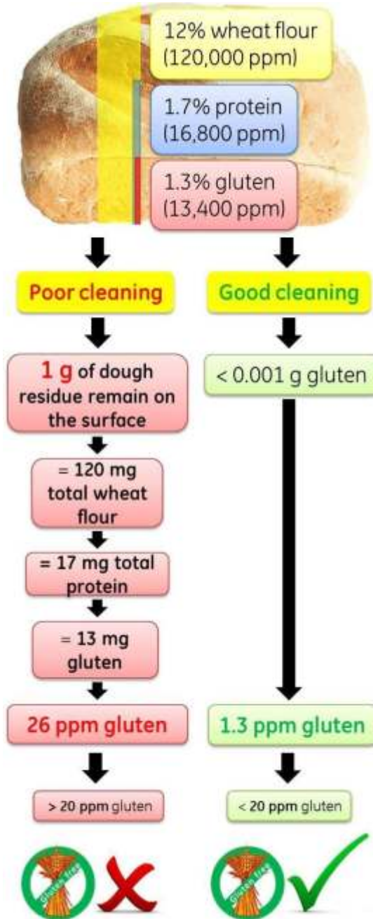
Theoretisches Beispiel für die Kontamination von glutenfreiem Brot mit Gluten aus dem vorhergehenden Produktionslauf, aufgrund von unzureichender Oberflächenreinigung.
